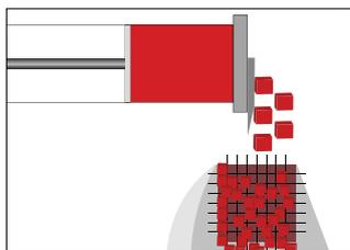
Автоматическая система предварительного сжатия обеспечивает оптимальное давление на продукт для придания точности реза на кубики и полоски.
