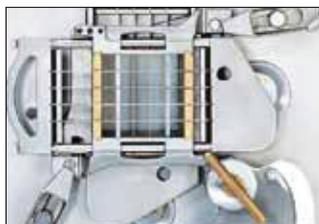
Дисковой нож с тефлоновым покрытием имеет уникальную заточку лезвия. Наряду с планетарной передачей данные характеристики позволяют нарезать свежеспеченный хлеб без смазки ножа.
