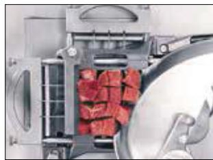
При помощи различных режущих решеток можно получить разные размеры кубиков. Возможны маленькие кубики до 4 мм.
